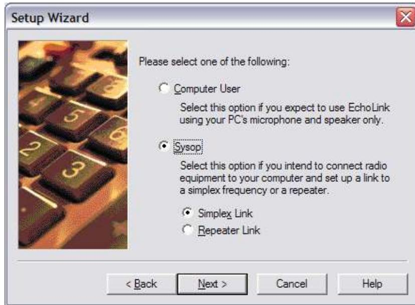
2 – Nesta tela (acima) você escolhe entre operar em uma frequência simplex (direta) ou operar em uma frequência de repetidora. Para a operar em simplex, escolha a opção "**Sysop**" e "**Simplex Link**". Para operar em uma frequência de repetidora, escolha "**Sysop**" e "**Repeater Link**".
