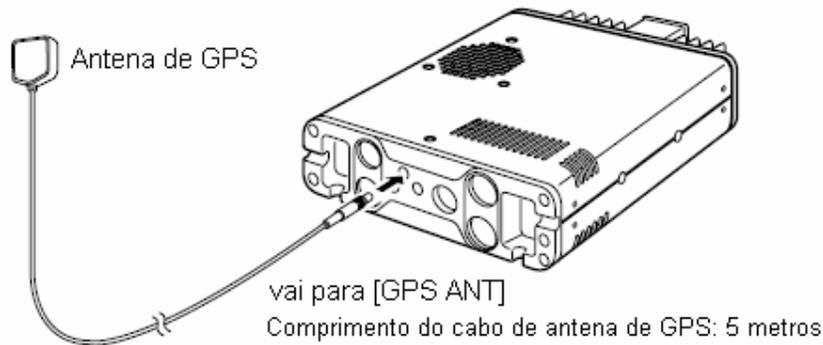
Monte a antena de GPS sobre uma superfície plana adequada. Ela inclui uma base de montagem com ímãs, portanto, pode ser montada sobre um teto de metal/uma parede, etc.
